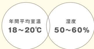
熱容量・透湿性を備えたこれからの断熱材「シュタイコ」は断熱性の高さはもちろん、他の断熱材にはない木繊維だからこそその魅力を備えています。熱容量や透湿性が高いのが最大の長場で、熱容量の高さは室温の平準化に寄与し、透湿性の高さは室内空気の調湿性に貢献します。
